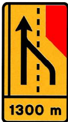
ST2 – Supressão de via de trânsito
